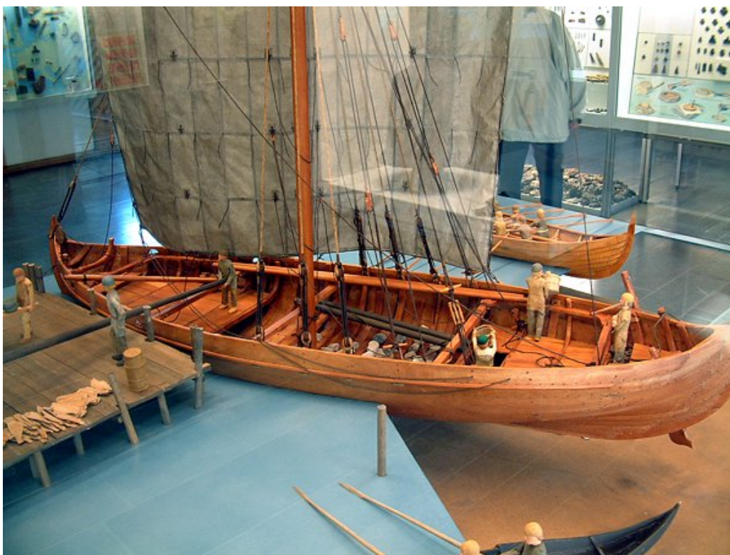
Rys. 2.5 Model knarra w Hedeby Viking Museum (Niemcy) [Knarr]. Łódź ma charakterystyczne półpokłady w części dziobowej i rufowej i otwartą przestrzeń ładunkową na śródkręciu.
