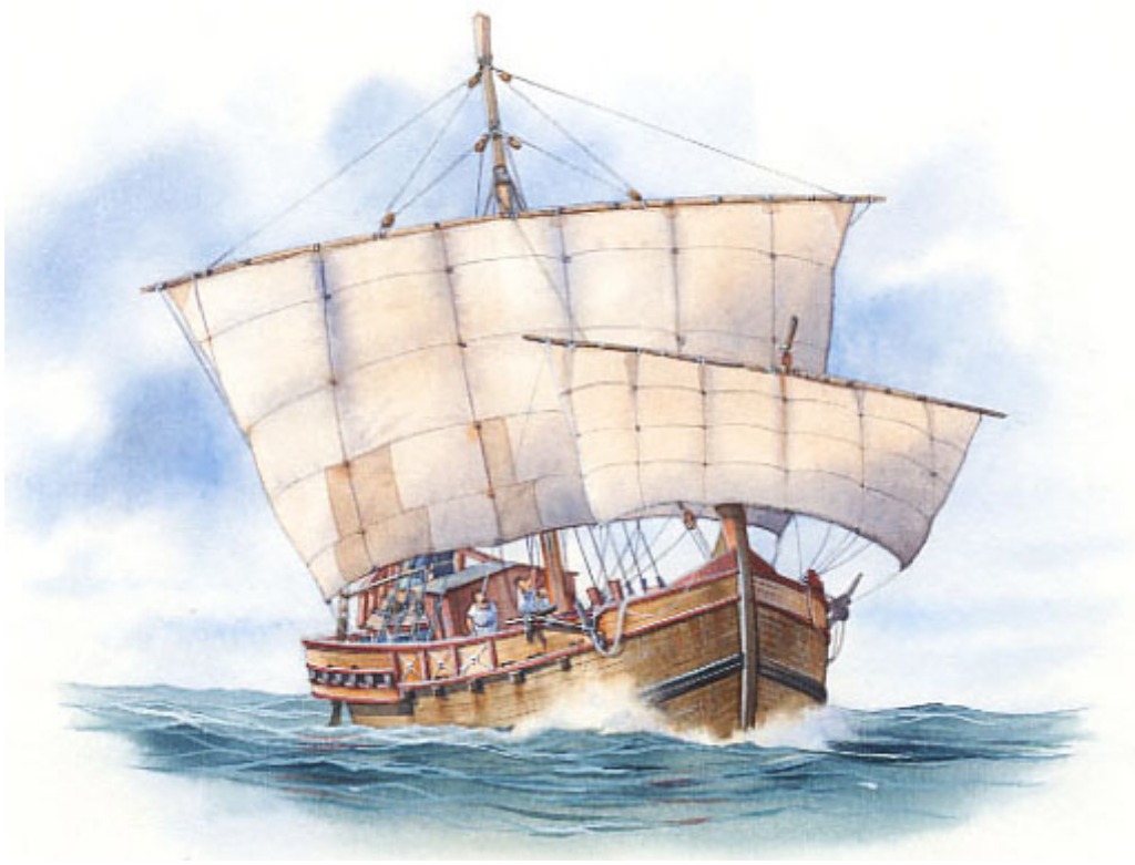
Rys 1.3 Rzymski statek handlowy epoki cesarskiej. Charakterystyczny wygląd ożaglowania. Żagle szerokie i niskie. W pełnym Średniowieczu nastąpiła zmiana. Maszty znacznie wydłużono i żagle stały się węższe, ale wyższe.
