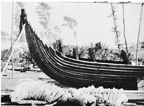
Rys. 2.27 Poszycie typu holk współczesnej łodzi z Pakistanu [McGrail 2003, str. 83]
