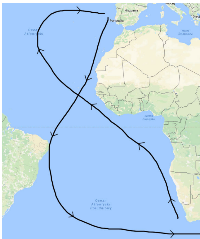
Rys. 7.6 Technika volta do mar largo w żegludze atlantyckiej do Przylądka Dobrej Nadziei i z powrotem. Żegluga na południe do Afryki południowej i na Ocean Indyjski z wykorzystaniem Prądu Brazylijskiego i Południowoatlantyckiego. Powrót z Afryki południowej i z Oceanu Indyjskiego z wykorzystaniem techniki volta do mar largo, ale
