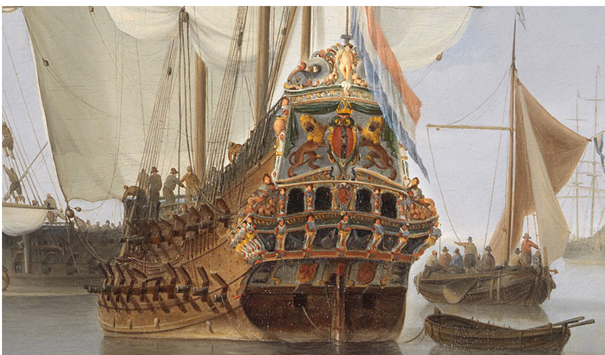
Rys. 9.7 Kasztel dziobowy i rufa galeonów holenderskich. XVII wiek. Choć są to okręty wojenne a ponadto z okresu wykraczającego poza naszą analizę, przedstawiają bardzo dokładnie podstawowe cechy rozpoznawcze konstrukcji, która pod koniec XV wieku ewoluowała z karaki. Bardzo niski kasztel dziobowy, wysoko wzniesiony, kilkupiętrowy kasztel rufowy, którego tył, nad pawężą, zdobi galeria lub kilka jej pięter i elementy ozdobne. Fragmenty obrazu Willema van de Velde Młodszego "Dutch men-o'-war and other shipping in a calm"
