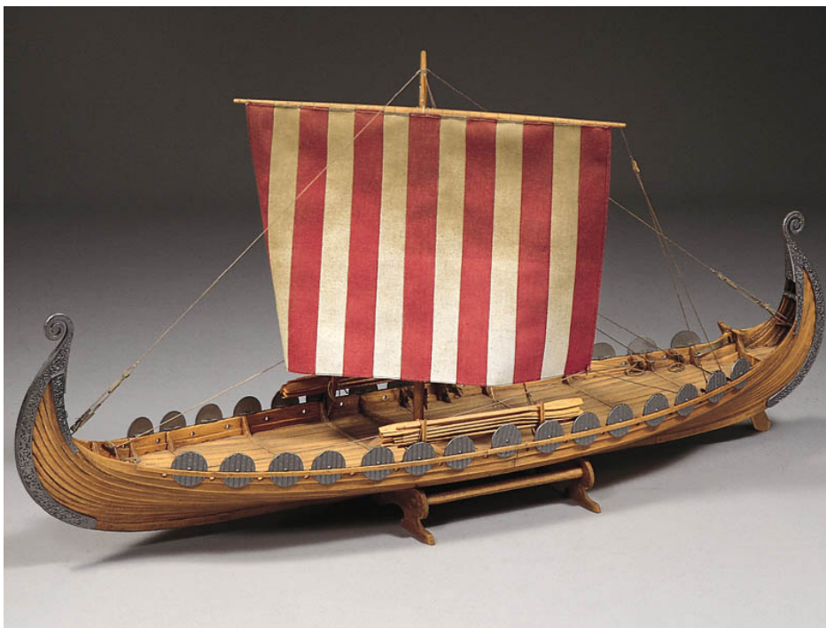
Rys. 2.3 Model długiej łodzi Wikingów. Okręt wojenny, długi i wąski. Stosunek długości do szerokości wikińskich okrętów wojennych wynosił od 5:1 do 11:1. Był to statek typu „double ended”, czyli konstrukcja rufy i dziobu takie same, co umożliwiała zmianę kursu do 180 stopni bez robienia zwrotu a jedynie przez zmianę pozycji wiosłarzy. Na burtach tarcze wojowników [Źródło: Early Atlantic Explorers]
