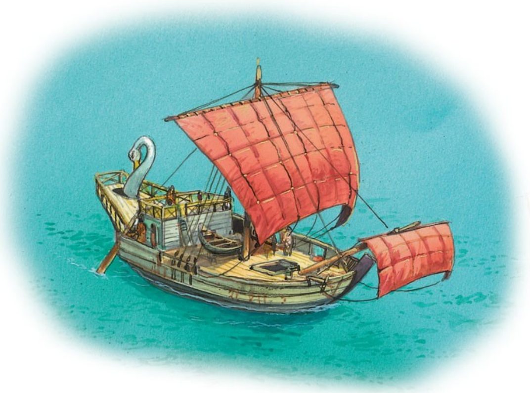
Rys. 1.1 Rzymski statek handlowy epoki cesarstwa. Pełnopokładowy. Na głównym maszcie żagiel kwadratowy, przedni maszt pochylony do przodu, także z żaglem kwadratowym. W tylnej części na pokładzie dobudowane pomieszczenia dla kapitana i oficerów. Charakterystyczny, ozdobny, wysoki tył.
