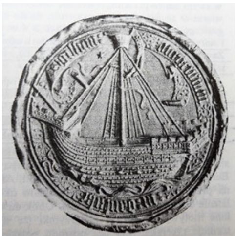
Rys. 2.29 Średniowieczne pieczęcie ukazujące holk hybrydowy. W części dziobowej (lewa strona statku) poszycie jest holkowe, natomiast poszycie części rufowej jest jak u kogi (prawa strona statku) [Adams, str. 107; Litwin, str. 151 /lewa pieczęć/; Greenhill, str. 6 /prawa pieczęć/]
