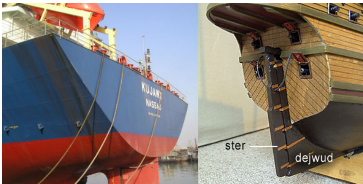
Rys. 2.19 Pawęż, czyli płaskie, zwykle pionowe zakończenie rufy nad linią wodną, na statku współczesnym (masowiec Kujawy, 39 tys. DWT, 2005) i na galeonie hanzeatyckim Adler von Lübeck (Orzeł z Lubeki, wyporność 2-3 tys. ton, 1566). Konstrukcja wprowadzona do statków Europy północnej w XIV wieku w celu zwiększenia ładowności i lepszego umocowania tylnego steru zawiasowego. Na zdjęciu modelu galeonu widoczny dejwud, czyli płaska konstrukcja drewniana, mocowana z jednej strony zawiasami do steru a z drugiej do zaokrąglonej, podwodnej części rufy. Dejwud zwiększa efektywność działania steru zawiasowego. (powrót do str. 44, 49)
