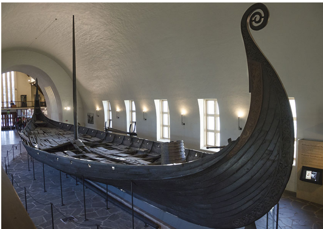
Rys. 2.2 Drakkar z Oseberg. Rok 834. Długość 21,6 m., szerokość 5 m., maszt 9-10 m., powierzchnia żagla ok. 90 m 2 (źródło: Oseberg Ship; Drakkar)
