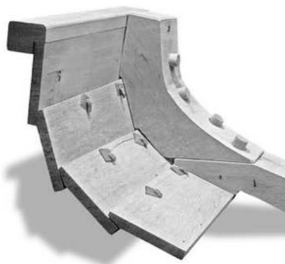
poszycie na zakładkę (clinker planking)
