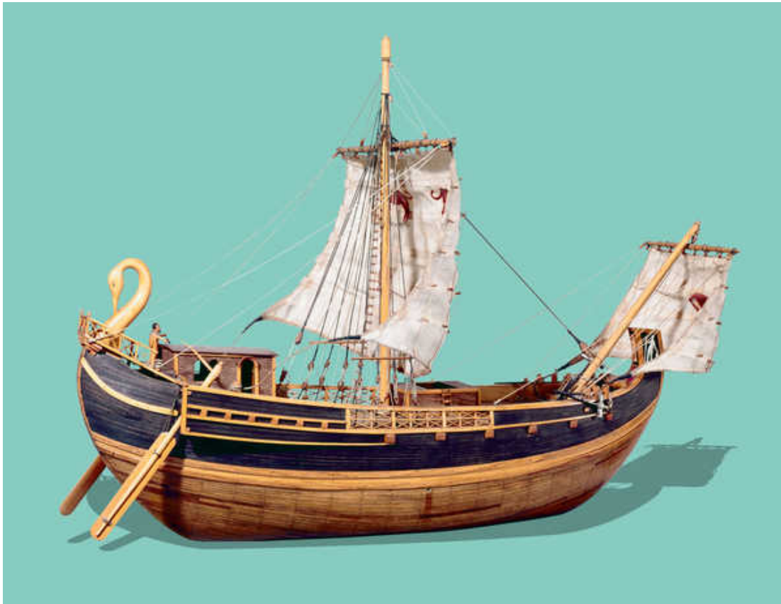
Rys. 1. 2 Rzymski statek handlowy epoki cesarskiej. przystosowany do żeglugi po Zatoce Biskajskiej. Widoczne dwa wiosła sterowe po obu stronach
