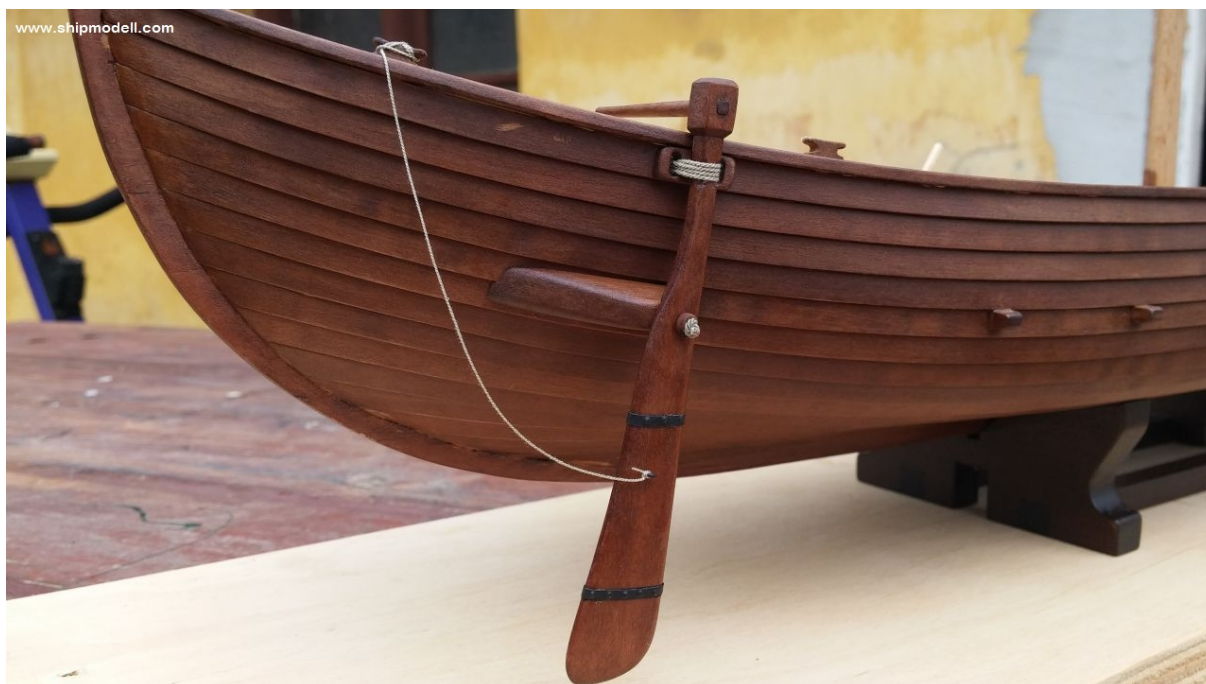
Rys. 2.18 Rekonstrukcja steru bocznego w modelu statku typu nef z XII wieku
