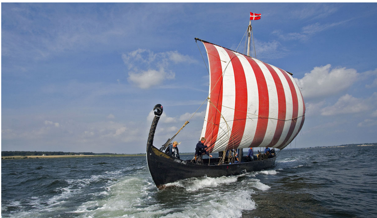
Rys. 2.4 Rekonstrukcja małej łodzi wojennej Wikingów. Wrak nosi nazwę Skuldelev 5, rekonstrukcja przedstawiona na fotografii ma nazwę Sebbe Als [ http://donsmaps.com/viking1.html ]. Jednostka zbudowana około roku 1024. Wymiary: 17,3 x 2,5 x 1,2 m. Posiadała 13 par wioseł.
